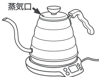
蒸気口が注ぎ口側になるようにフタをセットしてください。蒸気口からは高温の蒸気が出ます。ハンドル側にセットすると、注ぐ際にやけどをする恐れがあります。
